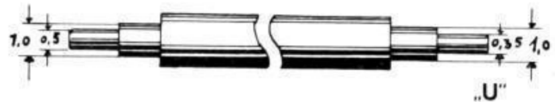
Stahlwelle mit Ansätzen – ein praktisches Werkzeug zum Ausdrücken des Spiralklötzchens und der Zeigerwelle
