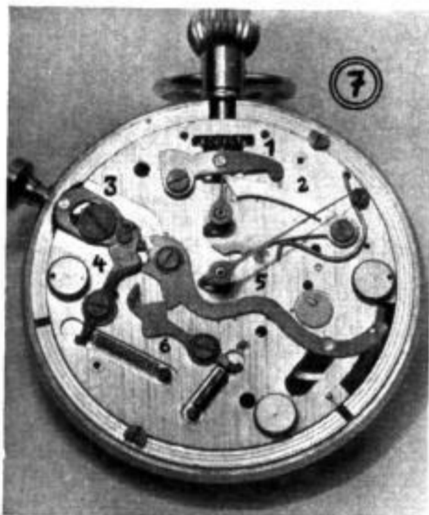
7. Der Mechanismus der „Additions-Stoppuhr“
