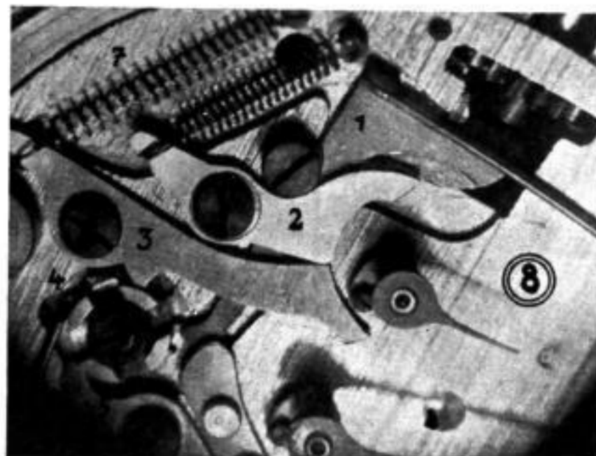
8. Schraubenfedern betätigen getrennt die Hebel für die Nullstellung
