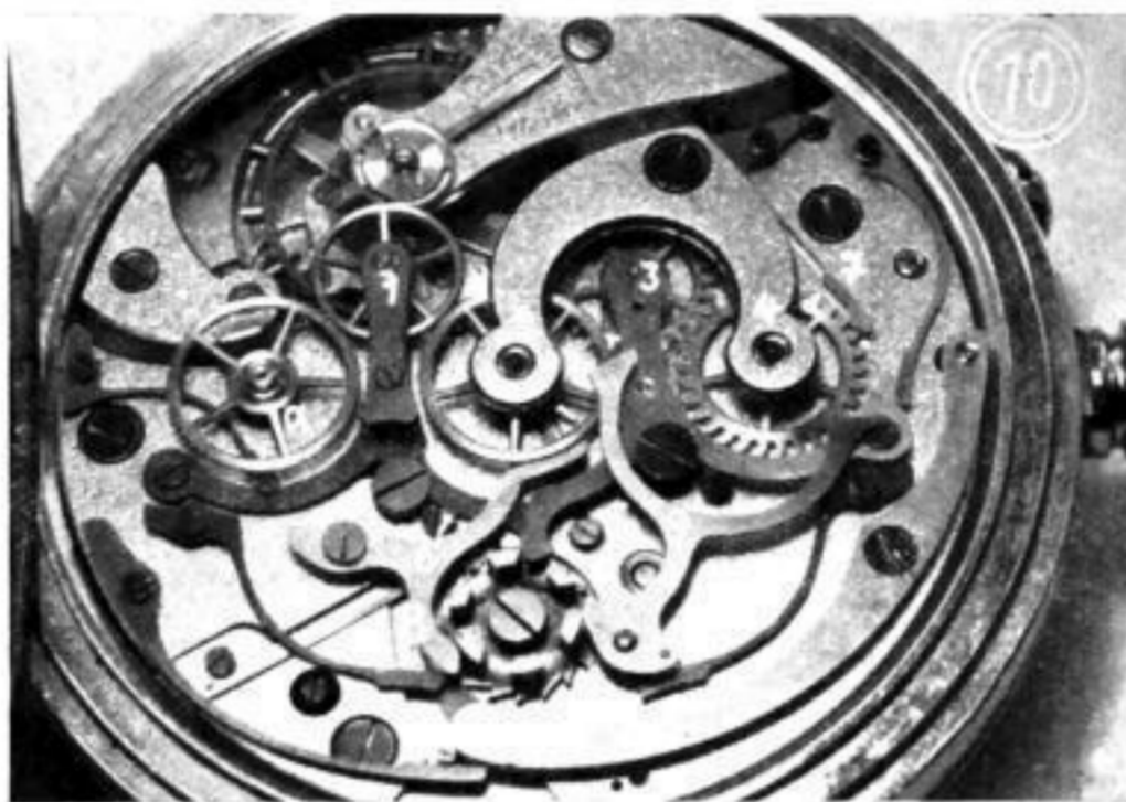
Abb. 10. Der Chronograph ist nichts anderes als eine Taschenuhr mit zusätzlicher Stoppuhr.
