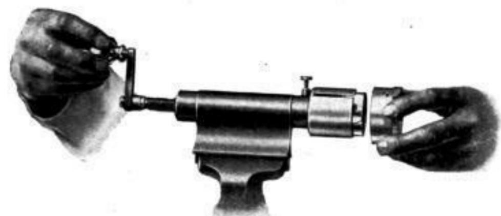
B) Einfügen der Feder aus dem Einsatz in das Federhaus
