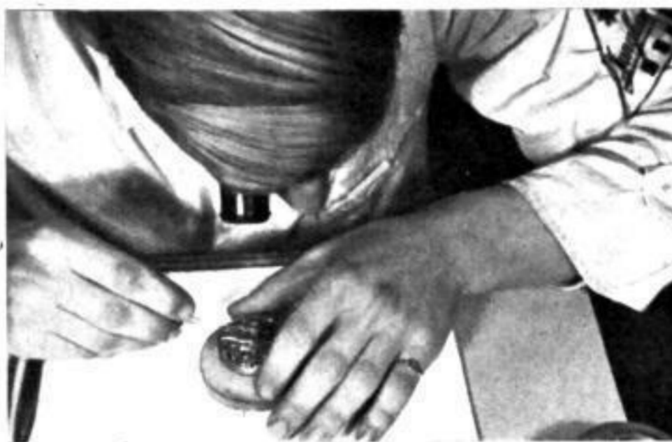
Remonteur beim Ölen einer Taschenuhr
