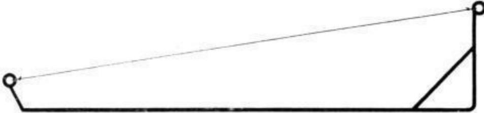
Der aus Draht gebogene Drehbogen, der so leicht ist, daß er in jeder Stellung stehen bleibt
