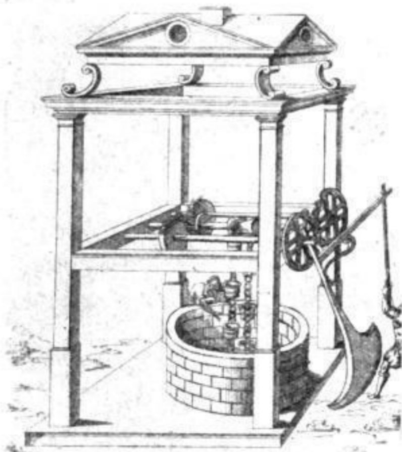
Abb. 5. Ziehbrunnen mit Schwungausgleichspendel. Nach J. Besson, um 1565.
