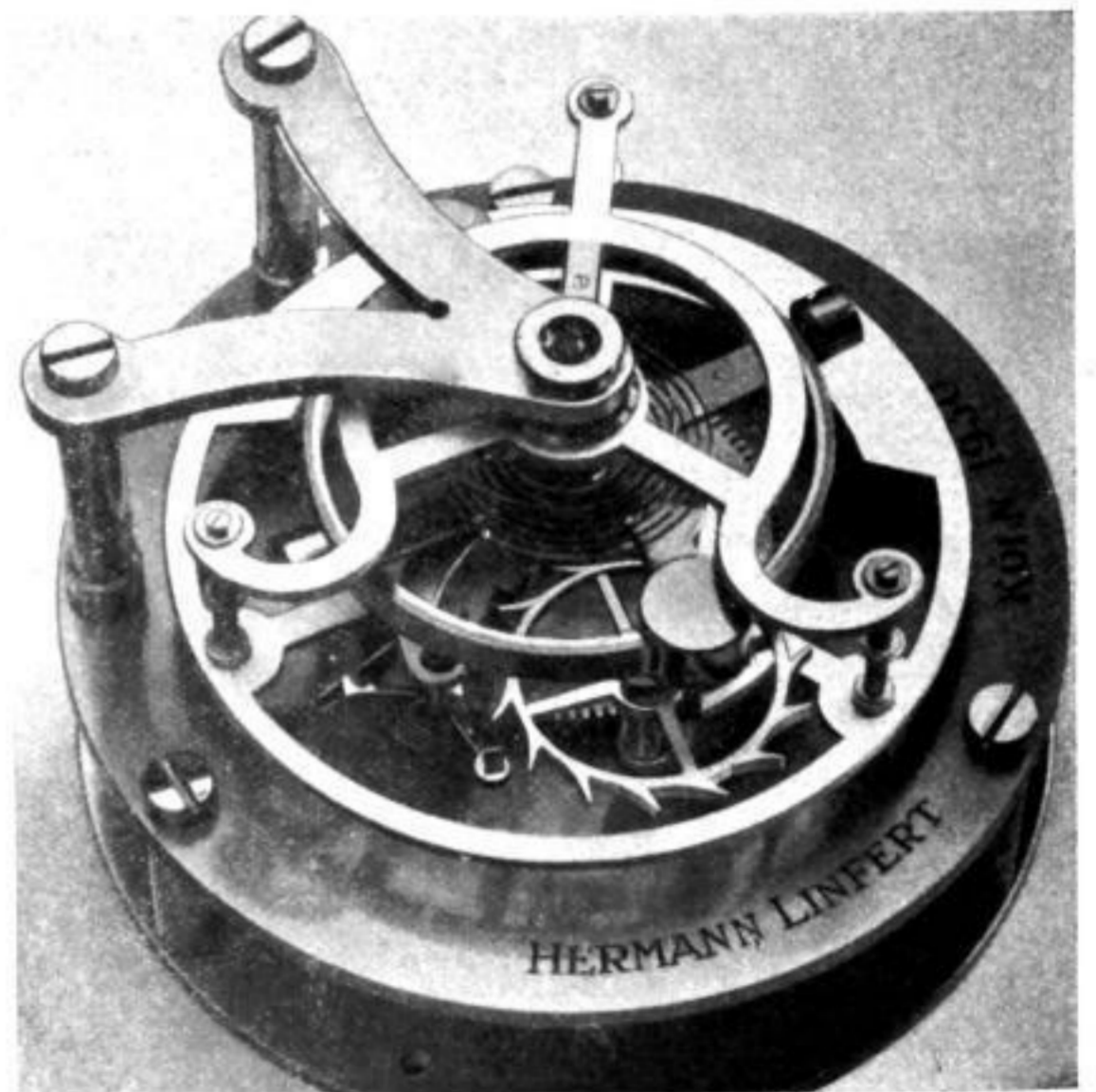
Chronometer-Tourbillon-Gangmodell. Anfertigt von Hermann Linfert in der Werkstätte der Firma Carl Jos. Linnartz, Köln
