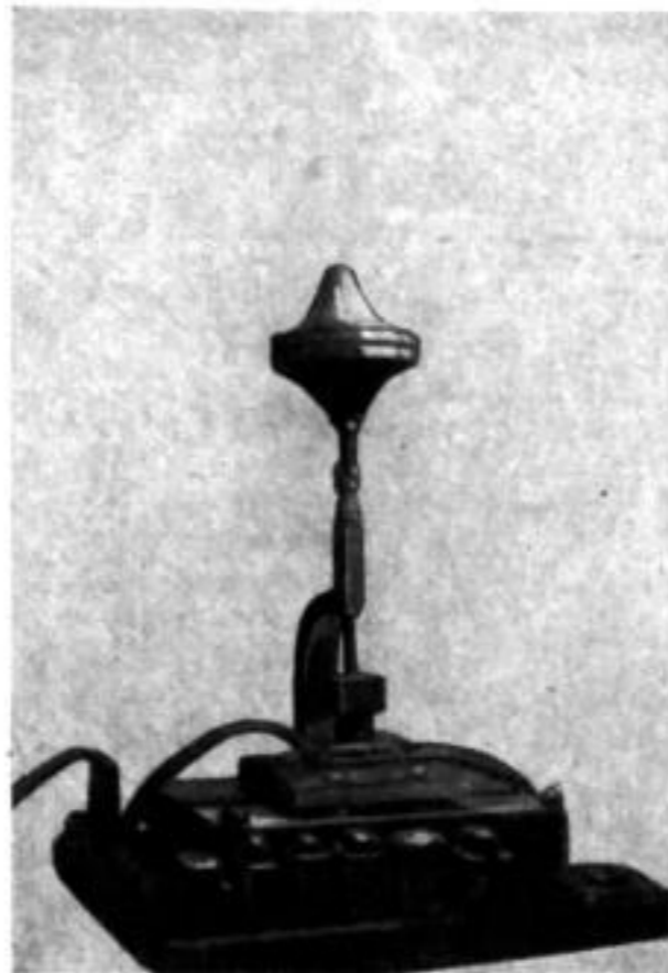
Formglasbiegeeinrichtung aus einer alten Geradbohrmaschine
