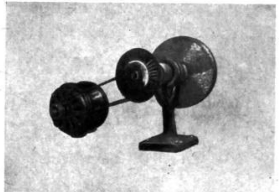
Die Polier- und Bohranlage (die Schleifscheibe wirkt hervorragend als Schwungrad)
