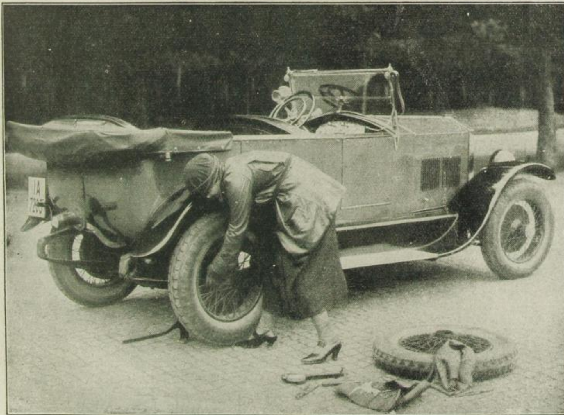
Das leicht auswechselbare Drahtspeichenrad enthebt den Automobilisten der Mühe, Pneumatikschäden unterwegs ausbessern zu müssen
