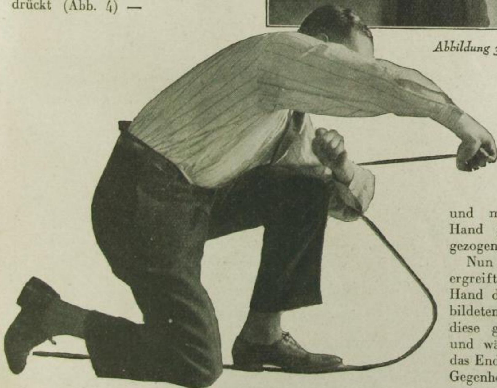
Lange Hebelarme erleichtern das Biegen. (Abbildung 4)
