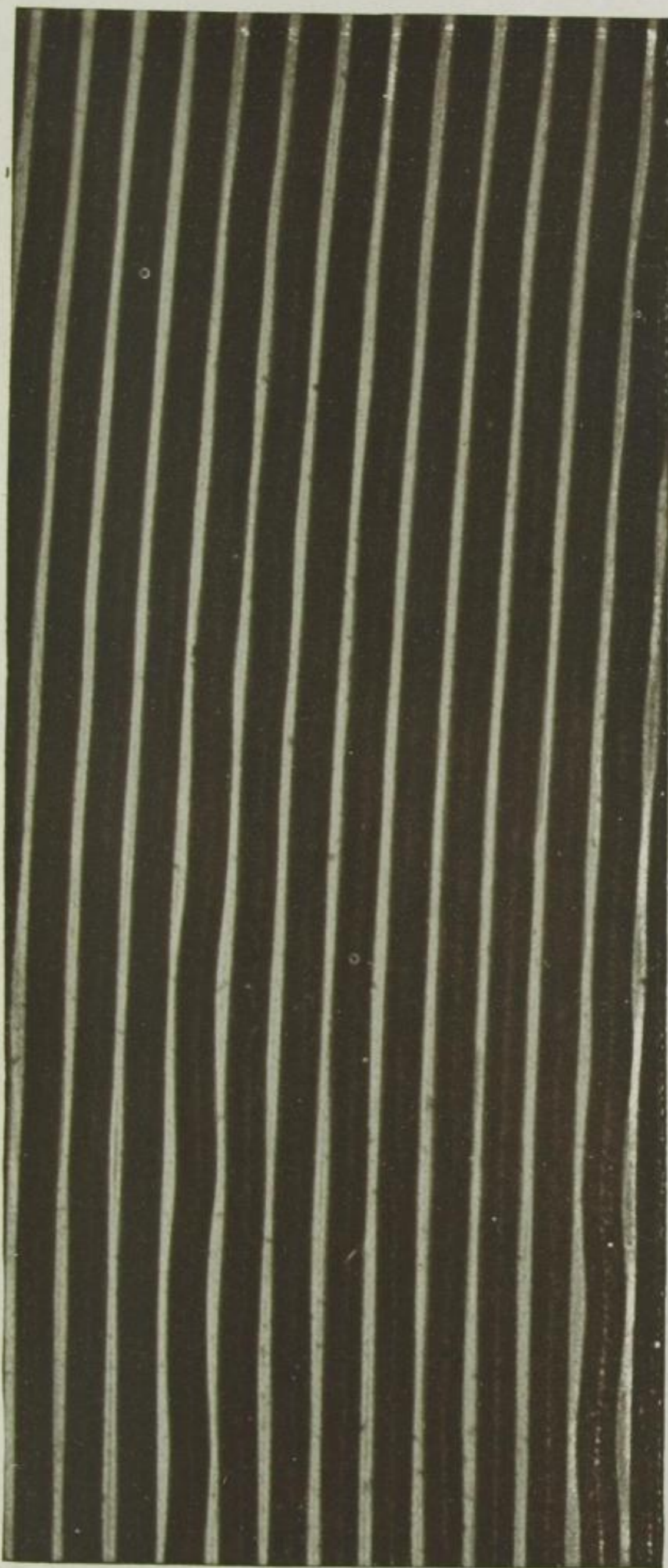
Das Wunder der Sprechplatte: Der Riesenchor von 6000 Stimmen in der Westminster Abbey in London auf der Breite einer Nadelspitze. 15fache Vergrößerung einer Singplatte.
