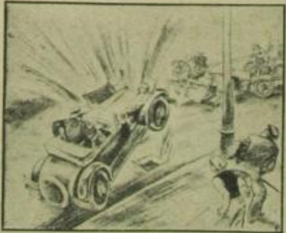
Nicht über Kanaldeckeln parken! (Ausströmende Gase können explosiv wirken.)
