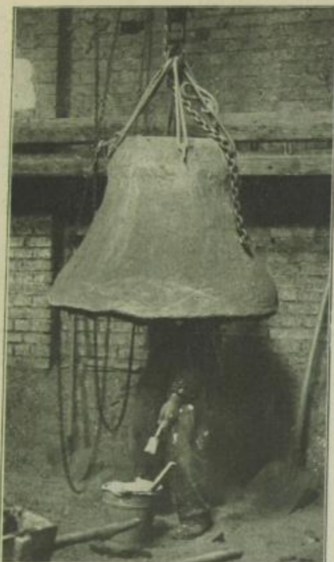
Der Zeichner unter dem Glockenmantel Der Mantel wird von innen weiß bemalt, damit die Inschriften und Verzierungen, mit denen die Glocke geschmückt werden soll, hineingeritzt werden können.
