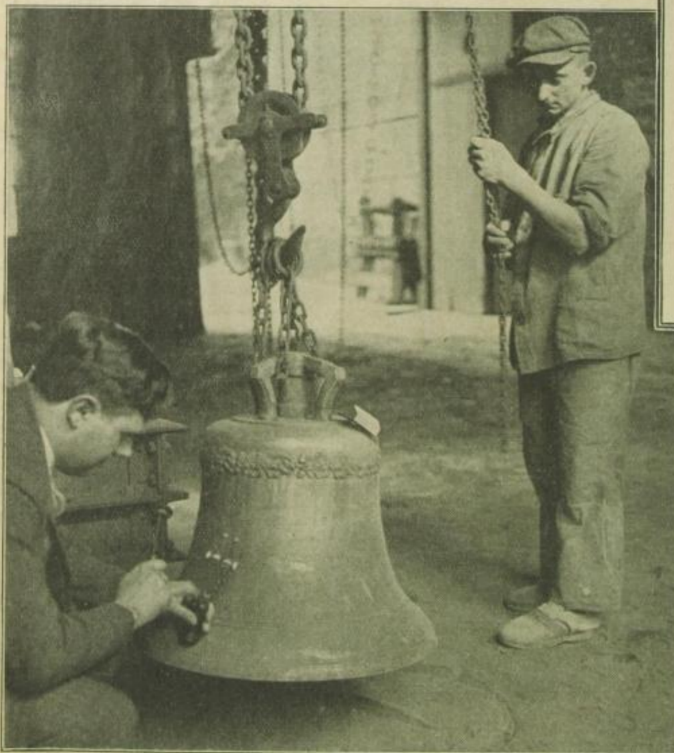
Die Glocke wird sorgfältig mit der Stimmgabel auf ihre Tonreinheit geprüft.
