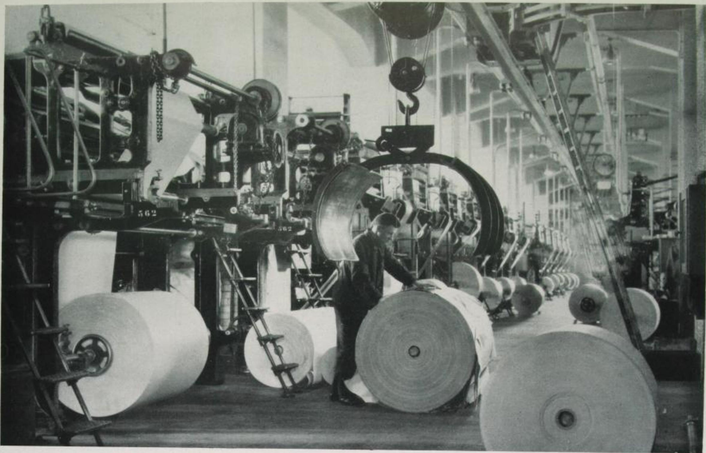
Aus dem Ullstein-Druckhaus in Berlin-Tempelhof: Blick in den Rotationsmaschinensaal der „Berliner Illustrierten Zeitung“ mit den riesigen Maschinenreihen und der Beförderungsvorrichtung für die schweren Papierrollen.
